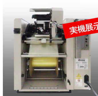
包装機 裏面 (Zerust®DEMO 用フィルム装着時)
